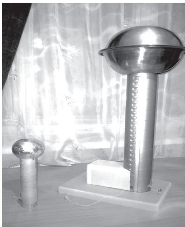
Рис. 2. Внешний вид генератора Ван-дер-Графа (учебная действующая модель)
