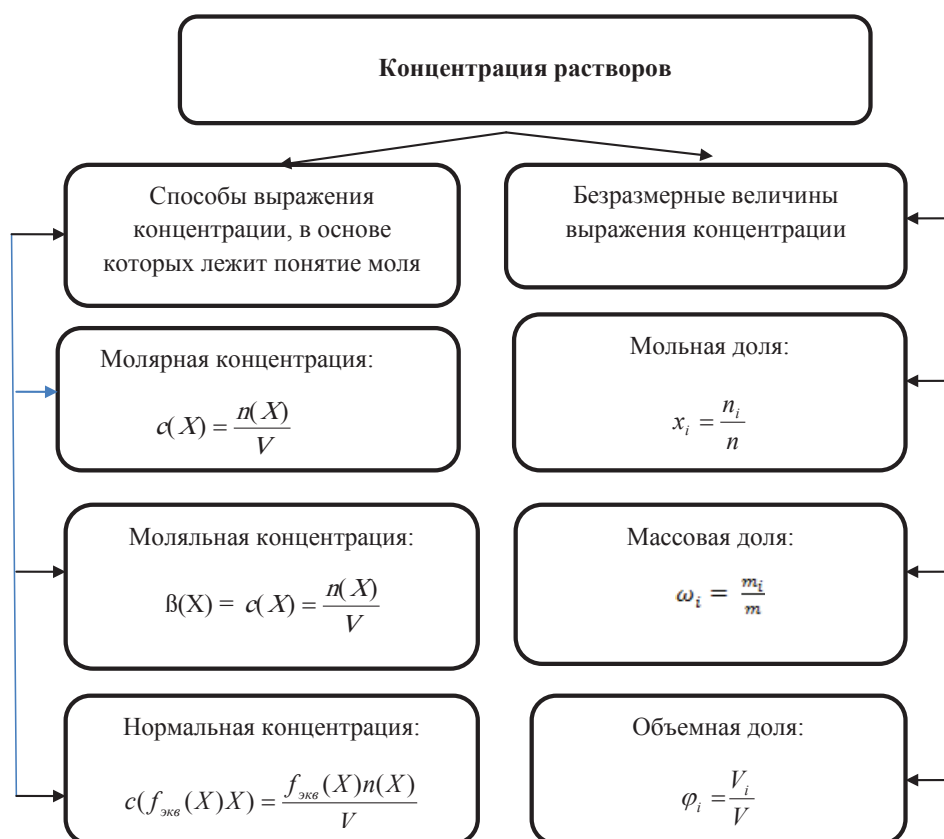
Рис. 6. Структурно-логическая схема «Концентрация растворов»
