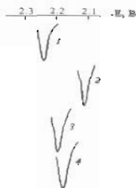
Рис. 2. Пики тока окисления амальгамы водорода, полученные для тройных амальгам Hg-M-H, снятые при развертке от -2,3 В без предэлектролиза и скорости развертки потенциала 20 мВ/с на 0,1 М MCl: 1 - (CH 3 ) 4 NCl; 2 - SrCl 2 ; 3 - CaCl 2 ; 4 - KCl
